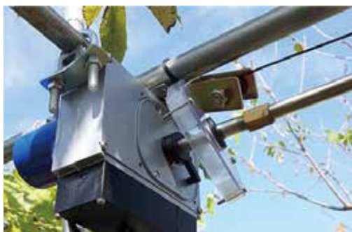
노즐, 구동장치, 각도조절 장치 구성 [그림 5] 수평 회전 구동장치
