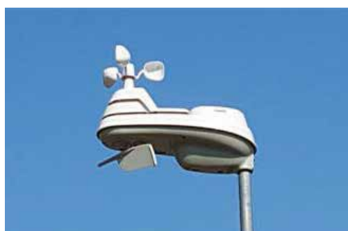
풍향, 풍속, 온도, 습도, 기압, 강우량 동시 측정 [그림 4] 기상대(기상측정기)
