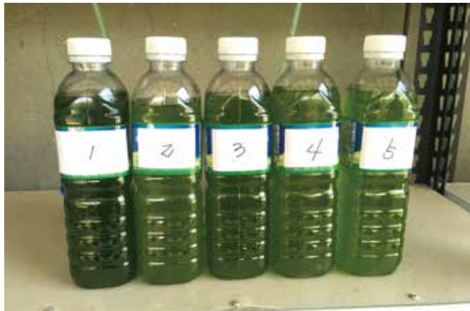
1. 자가배양기 표준 배양, 2. 보급배양기 표준 배양, 3. 보급배양기 비엠수원액 배양, 4. 보급배양기 비엠수배지 배양, 5. 보급배양기 혼합배지 배양
