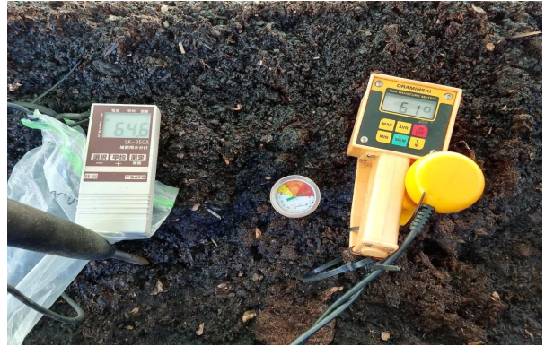
[그림 22] 온도, 습도, 암모니아 가스 측정
